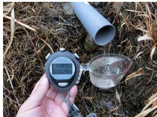
後法 漏水量測定(近景)
