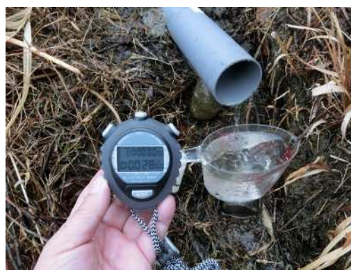
後法 漏水量測定(近景)
