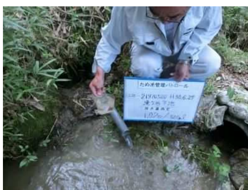
後法 漏水量測定(遠景)
