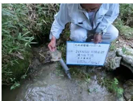
後法 漏水量測定(遠景)
