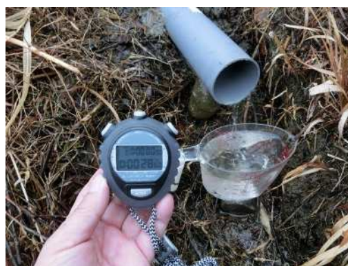
後法 漏水量測定(近景)
