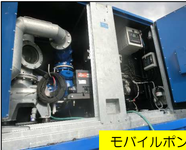
2トン車に積載したモバイルポンプ
