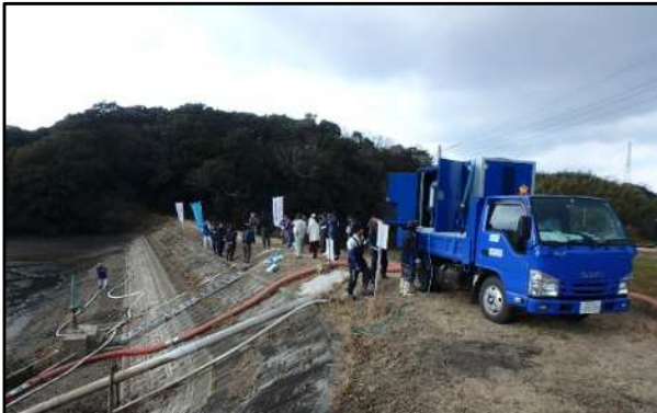
2トン車に積載したモバイルポンプ
