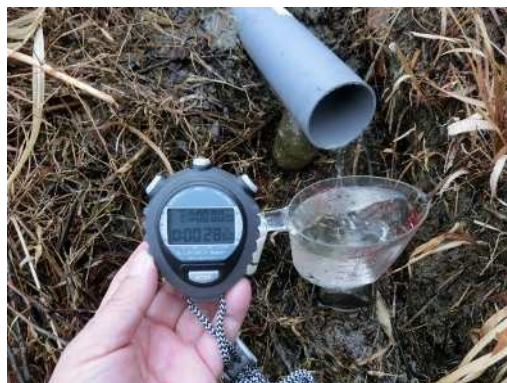
後法 漏水量測定(近景)
