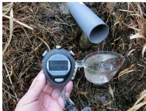
後法 漏水量測定(近景)
