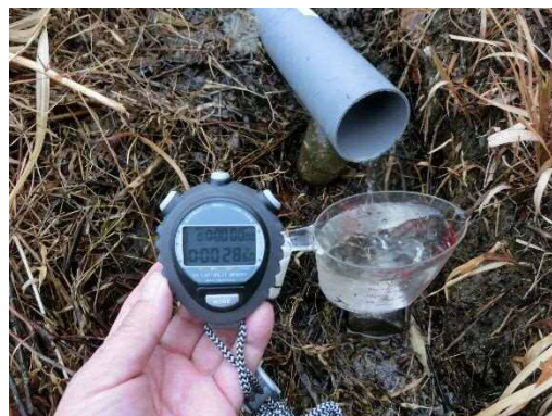
後法 漏水量測定(近景)
