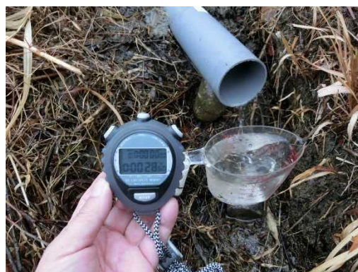
後法 漏水量測定(近景)
