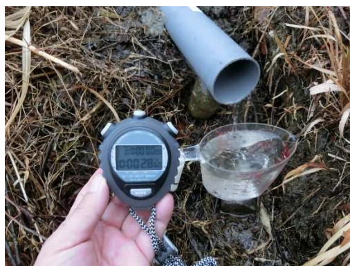
後法 漏水量測定(近景)
