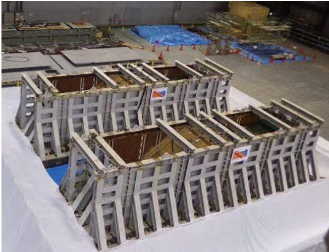
震動台の上に造成された2種類の堤体
